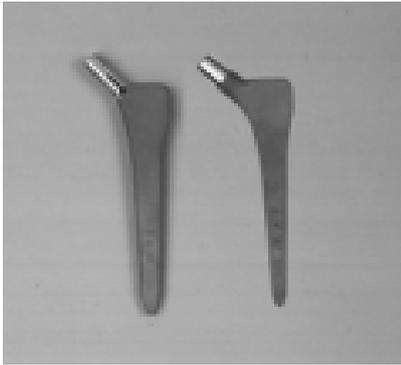
図3 S-4ステム(左)とDUETTO-SI(右)の外観
